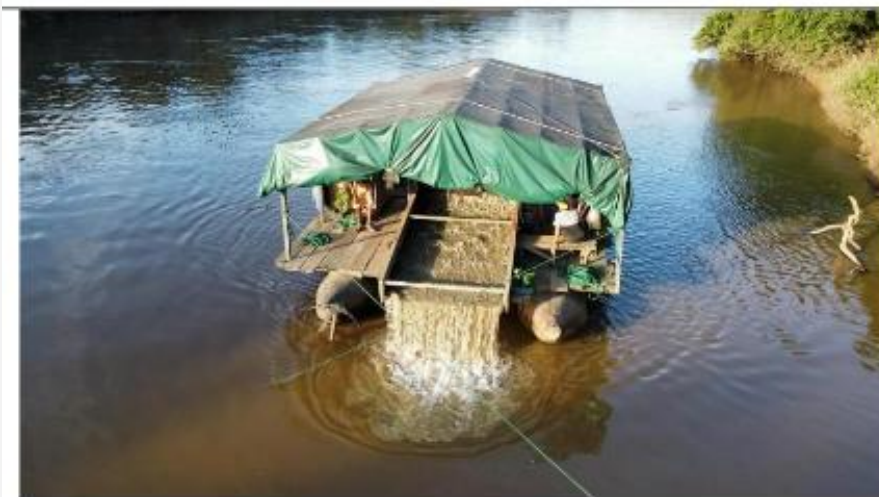
Figura 4: Draga com a caixa de retenção de concentrado. Fonte: PCA.
