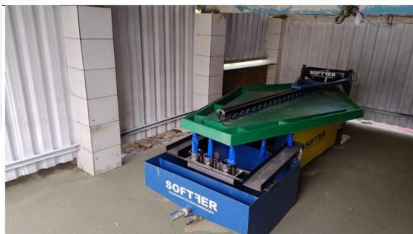
Figura 6: Mesa vibratória que faz a separação do concentrado por densidade. Fonte: PCA
