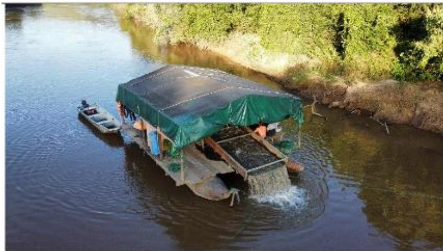
Figura 3: Draga utilizada no processo de extração de ouro no leito do Rio Verde nos limites dos direitos minerários. Fonte: PCA.
