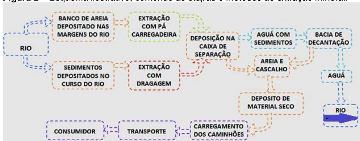
Figura 2 – Esquema ilustrativo, contendo as etapas e métodos de extração mineral.
