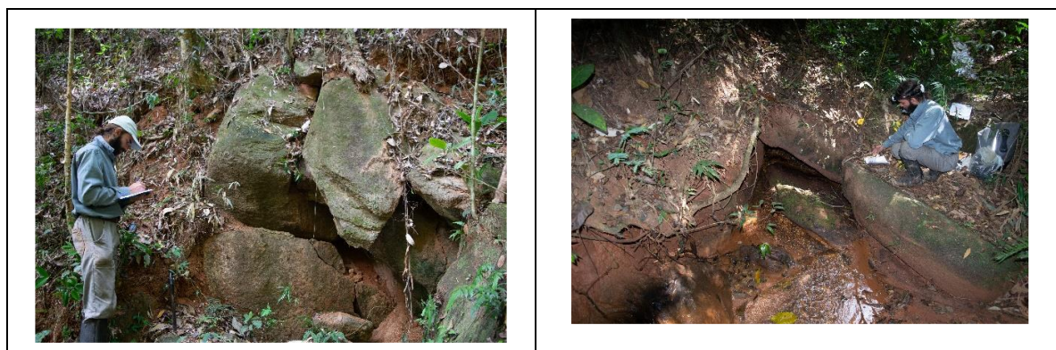
Figura 10. Fotos A e B, demonstrando a características das feições encontradas. * Em (A) maciço residual, onde se observar escorregamento de ganisse próximo do talvegue; em (B) depósito de tálus sobre cavidade. Ambas estão localizadas na porção sudoeste e em drenagem perene, na área de estudo. Fonte: Relatório de Prospecção Espeleológica, 2021.
