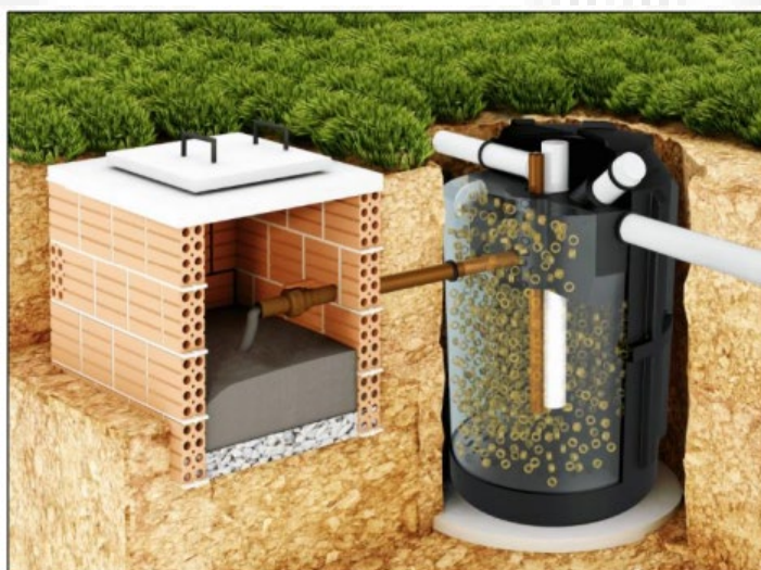
Figura 12: Modelo de biodigestor e leito de secagem.
